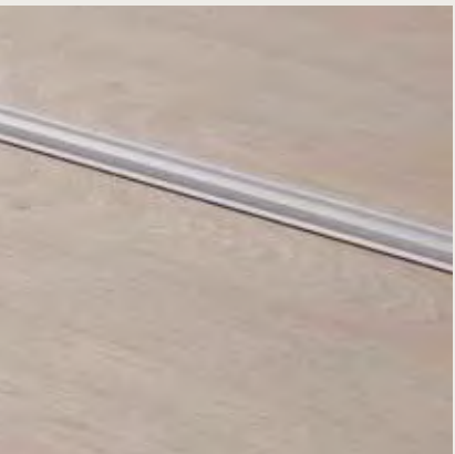
PROFILÉ COMBI, COULEUR ARGENT 1860 × 47 × 16 mm Profilé de dilatation et d'adaptation en un. Convient pour des différences de hauteur de 0 à 12,3 mm. Hauteur : 10 mm (non posé). Aluminium. PGPRSILV
