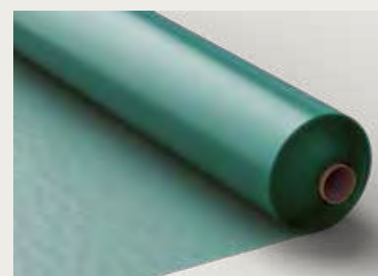
FILM PE (POLYÉTHYLÈNE) 12,5 × 2,7 m = 33,75 m 2 /rouleau. Protège le sol de la vapeur d'eau provenant d'un support minéral ou en béton. Durée de vie utile de 50 ans. Épaisseur : 0,2 mm. Matériau : polyéthylène, résistant aux alcalins.
